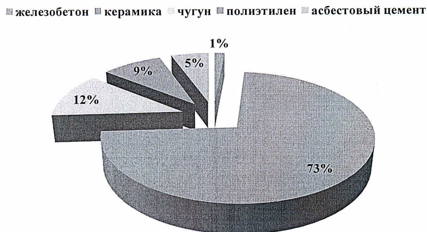
Рис. 1.5.1 Процентный состав материала трубопроводов сетей водоотведения
