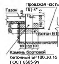
ДЕТАЛЬ УСТРОЙСТВА ПОНИЖЕННОГО БОРДЮРА
